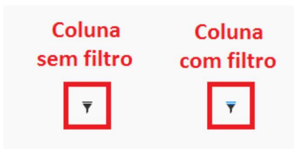
Figura II.2-5 – Diferença entre os símbolos de filtro para indicar filtro ativo ou não
